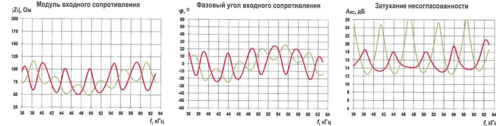
Рис. 12. Частотные зависимости параметров ВЧ тракта 2-ой группы при использовании аттенюатора (красная линия – режим XX, зеленая линия – режим K3)
