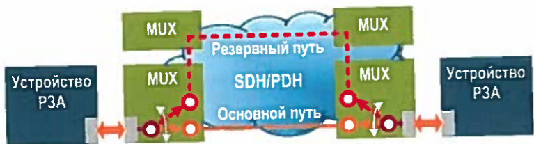
Рис. 5. Собственные механизмы резервирования сетей SDH/PDH
