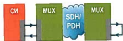
Рис. 8. Проверка синхронного канала для РЗА с помощью СИ в сетях SDH/PDH
