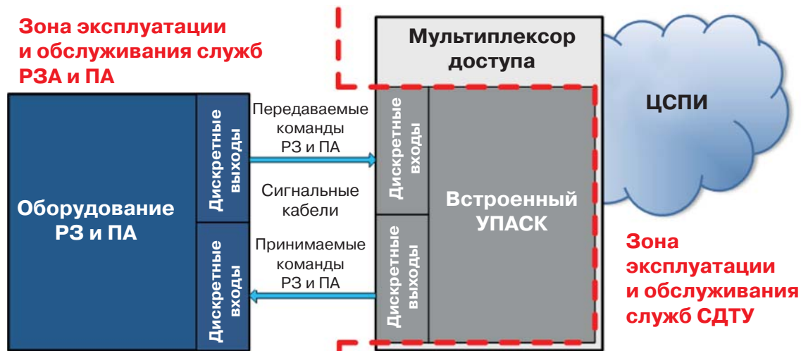
Рис. 1. Разделение зон эксплуатации и обслуживания в мультиплексе доступа со встроенным УПАСК
