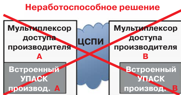
Рис. 3. Несовместимость встроенных УПАСК разных производителей
